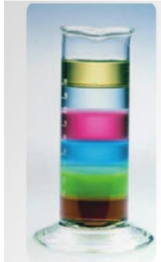
Figura 3.18 Los líquidos inmiscibles se separan en capas; el líquido más denso se va al fondo y el menos denso sube hasta la superficie. De arriba hacia abajo: aceite de maíz, agua, champú, detergente para vajillas, anticongelante y jarabe de arce.
