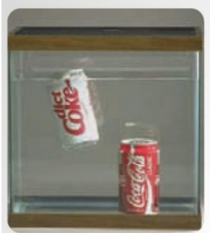
Figura 3.16 Una lata de bebida gaseosa dietética flota en el agua, no así la bebida gaseosa normal, debido a la diferencia de densidad entre ellas.
